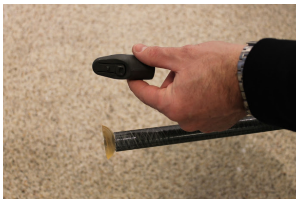
Til montering på vogn, skiftes Tectum kobling med sugekop, som skal stå ind på vognsiden som overligger. Krogen i modsatte ende sættes i Tectum-hjørnet. rediger
